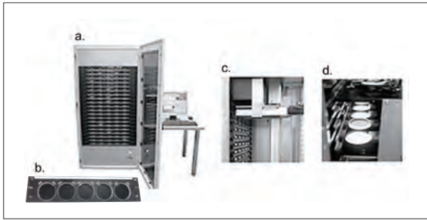
図3 MicroBio \mu 3D™の構成(主要ハードウェア) a. インキュベータ部(トレイ用20段)とコンピュータ b. トレイ(寒天培地シャーレ5枚装填可能) c. トレイ搬送ロボット部 d. 影像取得部
