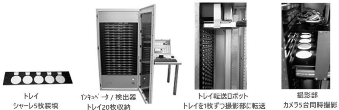
図 12 MicroBio μ3D AutoScanner のハードウェア
